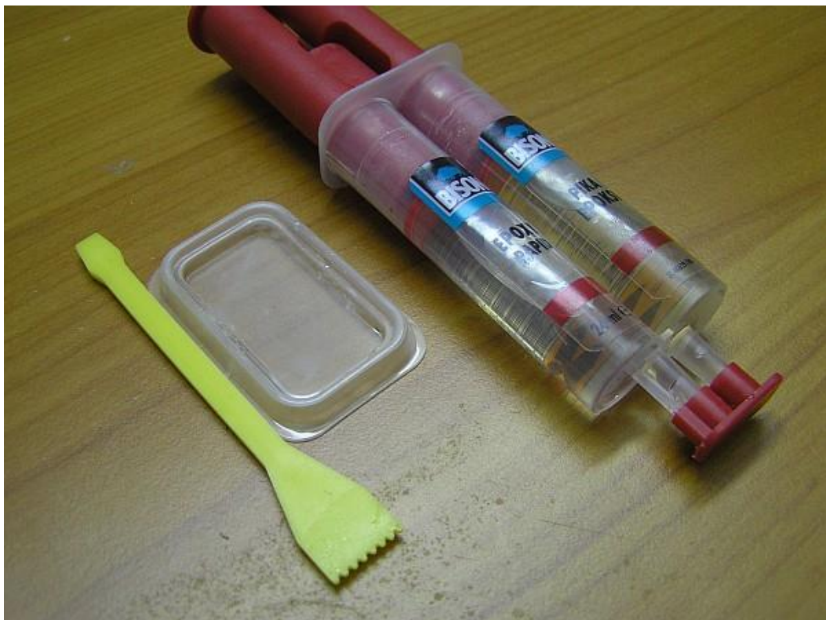
Pro pevné uchycení koleje na hraně modulu si rozdělám pětiminutové lepidlo Epoxy
