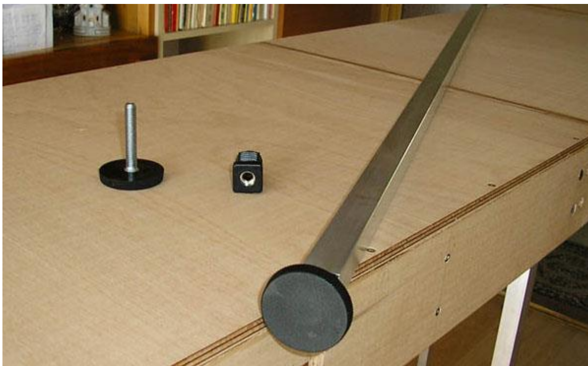
Pohled na nohu a její jednotlivé komponenty (zleva stavěcí šroub a stavitelná patka)
