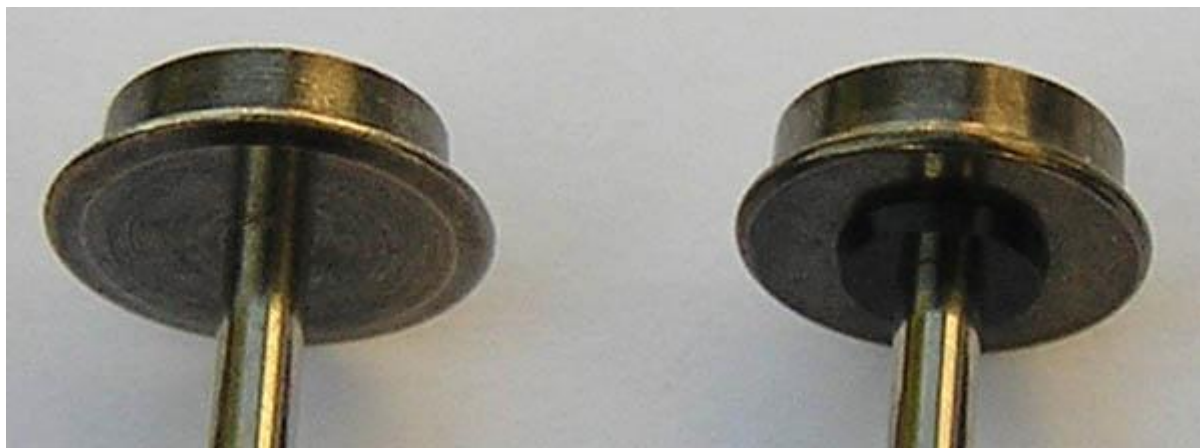
Srovnání kola nalisovaného bez izolace přímo na nápravu u jednostranně izolovaného dvojkolí (vlevo) a kola nalisovaného na nápravu s izolací (vpravo)
